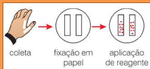
Figura 2 – No exame residuográfico, após fixação de tiras de papel, vestígios de chumbo na mão do atirador podem ser revelados com solução ácida de rodizonato de sódio
